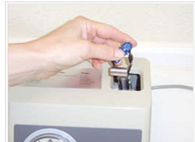
die Kapsel mit dem Quecksilber und den Silberspänen (durch eine Folie getrennt), wird in den Rüttler eingespannt, der Halter mit der Kapsel vibriert dann beim Anmischen sehr schnell hin und her
