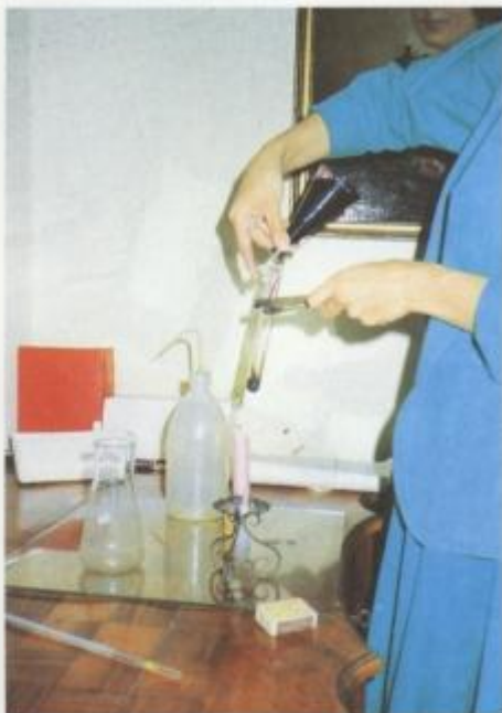
Abb. I – 8.2/4: Alkohol-Schnelltest im Urin mit primitivsten Mitteln. Ca. 5 ml Urin werden erhitzt. Eine kaliumpermanganathaltige 10%ige Natronlauge wird durch Alkohol in den Dampfswolken grün gefärbt. Bestätigung mit anderen Methoden!
