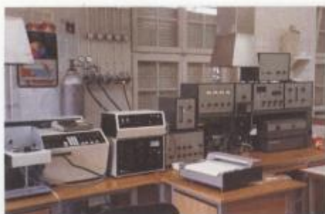
Abb. I – 8.2/8: Toxikologisch-analytisches Labor Neben den üblichen Chemie-Arbeitsplätzen u.a. mit Abzügen ist eine breite Meßplatzpalette und Computerspeicherung der Extinktionen nötig. Der Nachweis seltener Vergiftungen oder die Verlaufskontrolle z.B. von Alkylphosphatvergiftungen ist nur mit großem technischen Aufwand möglich. Fast nur rechtsmedizinische Labors verfügen über entsprechende Erfahrungen.
