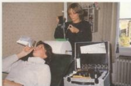
Abb. I – 8.2/3: Gasspürgerät mit Palette der Prüfröhrchen in der Ausatemluft Liegend: Alkotest quantitativ in der Ausatemluft Stehend: Blausäure-Schnelltest im Blut. Koffer: Prüfröhrchen von der Fa. DRÄGER (Lübeck). Von den etwa 800 verschiedenen Prüfröhrchen sind nur 40 zum Giftnachweis in der Ausatemluft eines Vergifteten geeignet. (Siehe Tabelle Diagnose in der Ausatemluft.)
