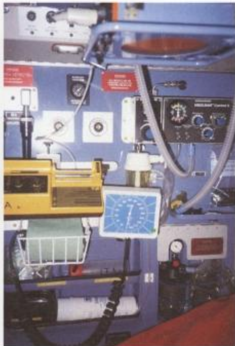
Abb. I – 8.1/9: Heutiges Sauerstoff-Beatmungsgerät (Medumat Control 3) im Rettungshubschrauber BK 117, München.
