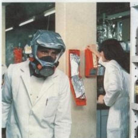
Abb. I – 8.1/1a: Rettung aus Gasmilieu Griffbereite Fluchthauben am Arbeitsplatz. Nur wenn die Anwendung regelmäßig, alarmmäßig geübt wurde, kann in der allgemeinen Verwirrung des Ernstfalles ein sinnvoller Schutz für die Flucht erfolgen.
